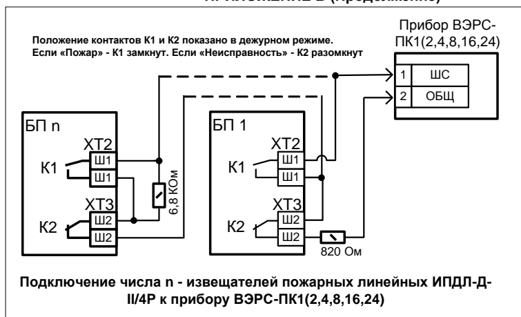
Рисунок Б5. Схема включения линейных дымовых извещателей ИПДЛ-Д-II/4Р.
